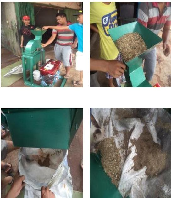
Gambar 3. Uji Coba Mesin pengolah limbah ikan
